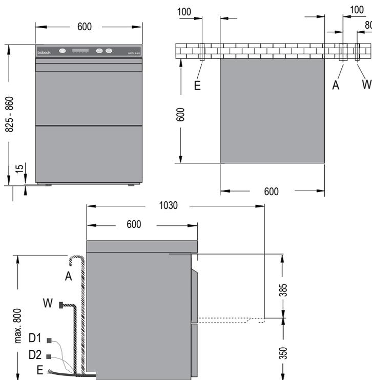
\*Option E : mit eingebautem Wasserenthärter
